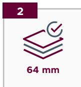
2 Skrzydło drzwiowe z uszczelką, wielo- warstwowym wkładem oraz ramiakiem z drewna klejonego 64 mm
